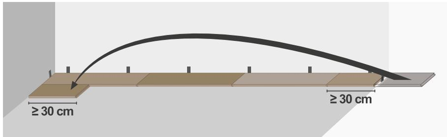
**ВНИМАНИЕ!** После того, как Вы уложили первую планку второго ряда, укладывать следующие планки следует со стороны короткого паза. Прежде чем вставить планку в паз длинной стороной, немножко приподнимите обе планки второго ряда, и далее прижмите их к полу.
