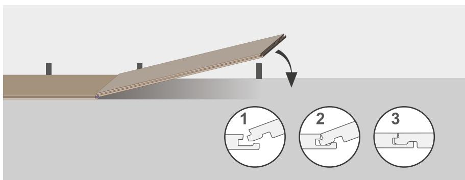
3. Продолжайте укладывать таким же образом до противоположной стены. Если последняя планка слишком длинная, подрежьте ее и уложите для завершения ряда, соблюдая зазор.
